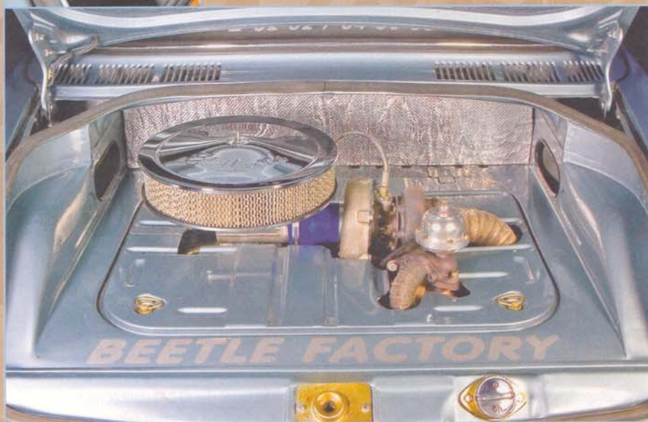
Oben: Christians Konstruktion ist noch im Test-Stadium, die Luftzufuhr für den Vergaser ist noch nicht zufriedenstellend Links: FK-Druckanzeige und Dampftrad zum Einstellen des Ladedrucks Rechts: Momentan ist die hintere Haube zur besseren Luftzufuhr leicht aufgestellt, doch auf Dauer soll sie wieder geschlossen sein
