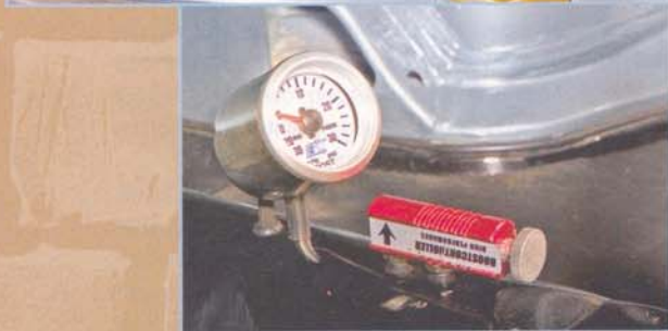
Oben: Christians Konstruktion ist noch im Test-Stadium, die Luftzufuhr für den Vergaser ist noch nicht zufriedenstellend Links: FK-Druckanzeige und Dampftrad zum Einstellen des Ladedrucks Rechts: Momentan ist die hintere Haube zur besseren Luftzufuhr leicht aufgestellt, doch auf Dauer soll sie wieder geschlossen sein
