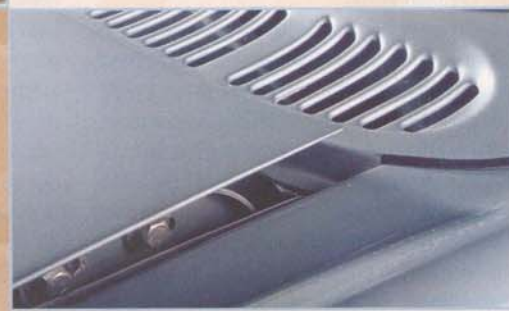
Oben: Christians Konstruktion ist noch im Test-Stadium, die Luftzufuhr für den Vergaser ist noch nicht zufriedenstellend Links: FK-Druckanzeige und Dampftrad zum Einstellen des Ladedrucks Rechts: Momentan ist die hintere Haube zur besseren Luftzufuhr leicht aufgestellt, doch auf Dauer soll sie wieder geschlossen sein
