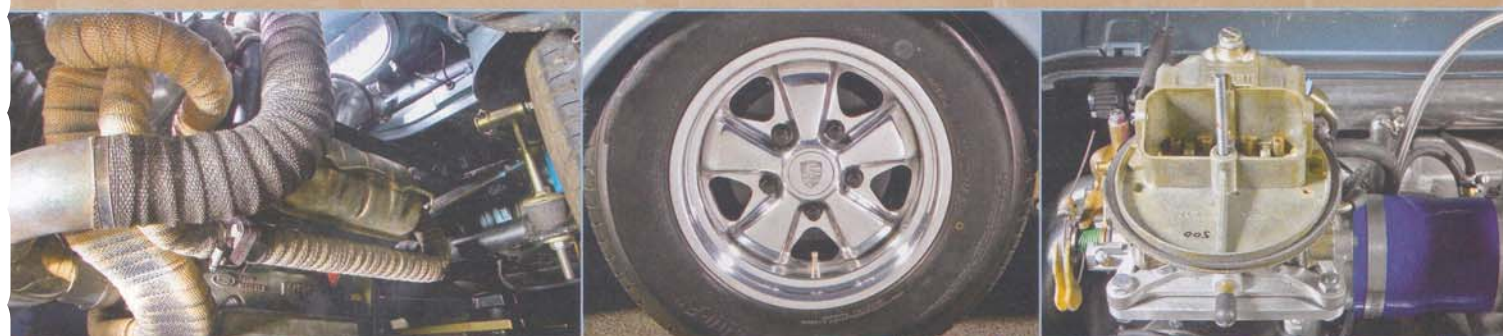
Links: Christian entwickelte den Motor zusammen mit seinen Compagnons Andreas und Martin Bröcking Oben links: Mit Thermo-Tec-Band umwickelter Eigenbau-Krümmer Oben Mitte: Die Antriebsachse trägt aufgeschweißte 7x14er Füchse mit 205/70er Toyos Oben rechts: Ein gewaltiger Holley 500 versorgt den 2387 ccm großen Typ 3-Motor Rechts: Der Kofferraum ist makellos und erstrahlt wie der Rest der Karosserie in Fimblaumetallic, eine Farbe aus der 58er Käfer-Palette
